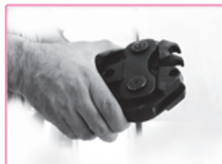
طریقه نصب قالب ۶۳ بر روی فک اختصاصی آن
