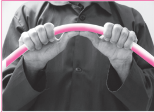
نحوه اصولی خم نمودن لوله با دست
